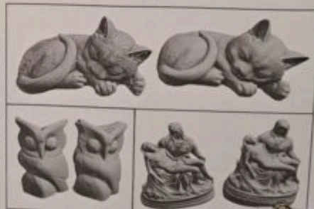
Rys. 3. Porównanie modeli skanowanych telefonem oraz skanerem ze światłem strukturalnym
