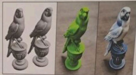
Rys. 2. Porównanie modeli skanowanych telefonem oraz skanerem ze światłem strukturalnym, model drukowany FFF oraz model rzeczywisty
