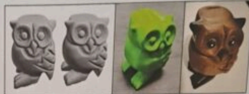
Rys. 1. Porównanie modeli skanowanych telefonem oraz skanerem ze światłem strukturalnym, model drukowany FFF oraz model rzeczywisty
